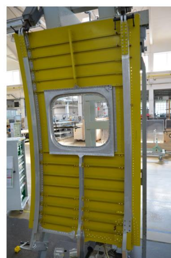
Widok panelu w przyrządzie montażowym
